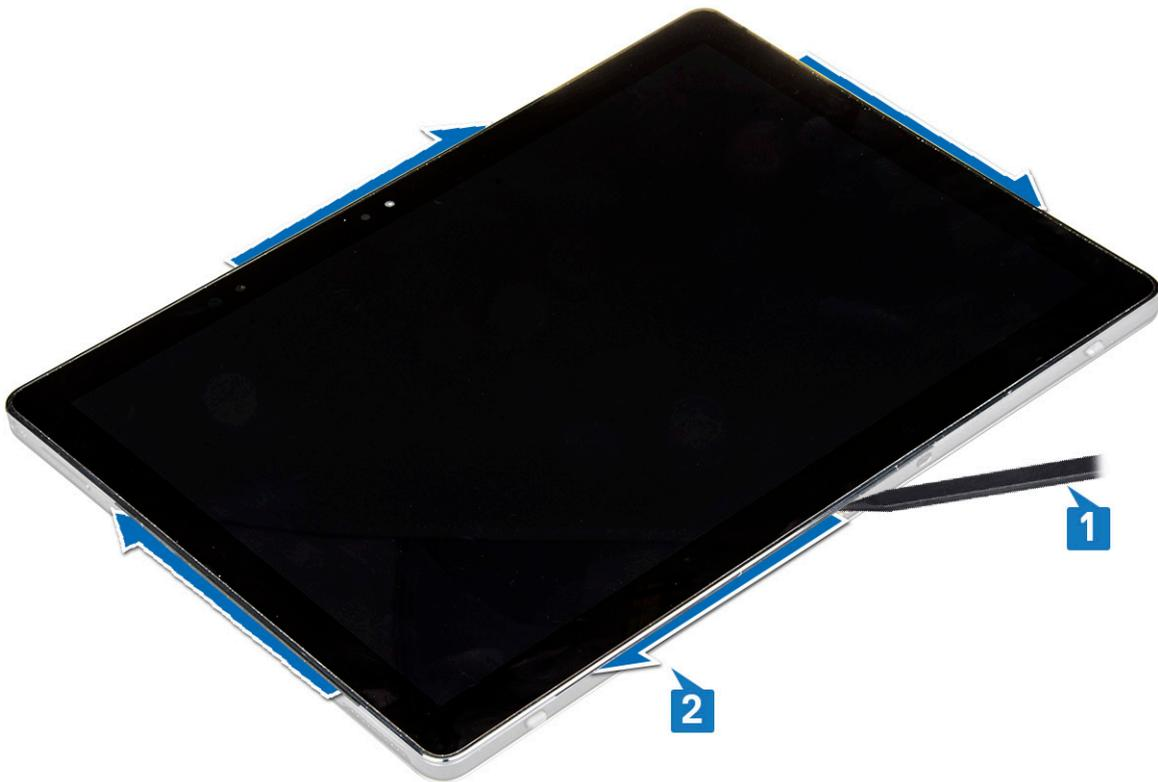
7. 将显示屏面板置于平坦的表面上，显示屏面朝下放置。
