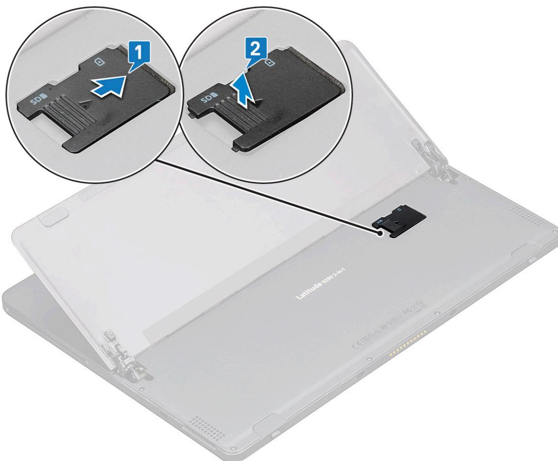
7. 您可以执行相同的步骤以卸下 MicroSD 或 Micro-SIM 卡
